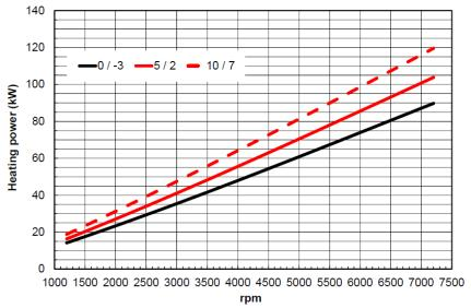
**ELECTRIC POWER (400 V 3/N/PE).** Heating 30/35 °C. Brine 0/-3, 5/2 y 10/7.
